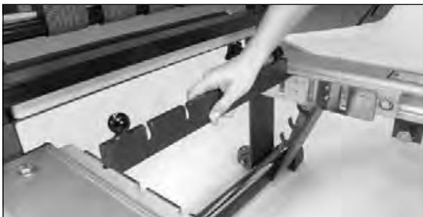
**5.** Ajuste la barra de sujeción de muelles en la posición No. 1.
