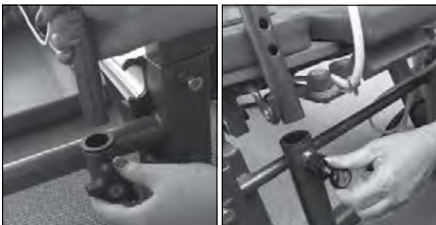
5. SPX 맥스: 폴리 포스트[27]를 리포머 뒷면의 리셉터클[23]에 삽입하고 별모양 손잡이[36]를 꼭 조입니다. 폴리 포스트 위의 아이혹 [52]이 레일과 평행하도록 하십시오.
