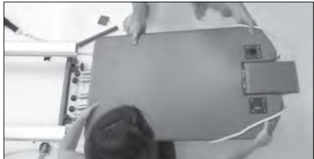
4. 고정 롤러[37]를 C-채널 [51]에 정렬시킨 다음, 필요에 따라 플로팅 롤러[38]를 조정합니다. 그 다음 캐리지[15]를 레일[14]에 끼워 넣습니다.
